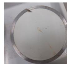
図1 模擬炭酸沈殿の工学規模固化体
