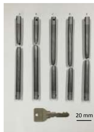
図 1:EB 溶接した被覆管・端栓接合体の室温引張試験した場合の破断の様子
