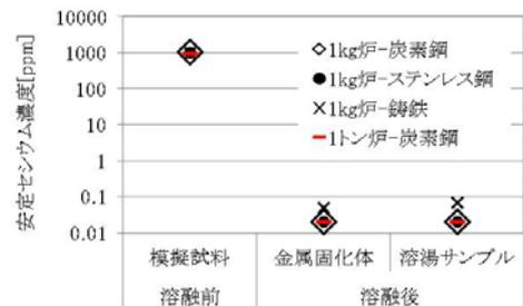
図 1 模擬試料を用いた除染試験における金属中の安定セシウム濃度
