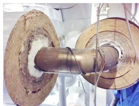
図 2 エルボ配管に実装した FBG センサ
