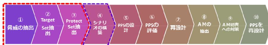
図1：核セキュリティのための物理的防護システム(PPS)構築のプロセス
