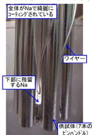
図 2 供試体への Na 残留状況
