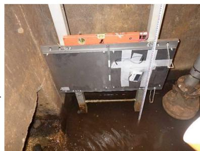
図2 サブドレン内の原子核乾板設置状況
