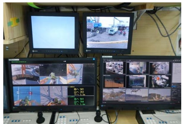
写真1 誘導モニター (複数のカメラ映像、吊り治具の位置を数値で表示)
