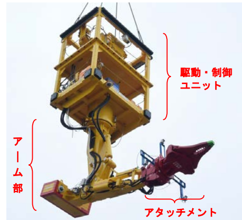
写真5 装置全景 (クレーンで吊り下げて使用) 重量：約18t 駆動装置：油圧
