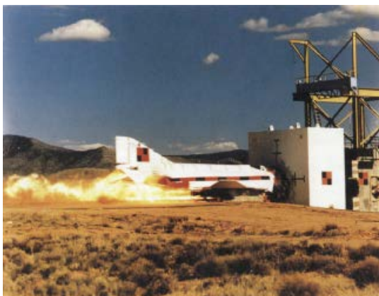
写真2 F4-Phantom 戦闘機を用いた衝撃実験状況 5)
