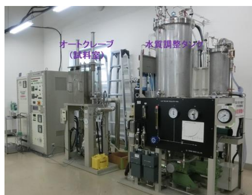
図 1 高温高圧水環境下材料試験装置外観
