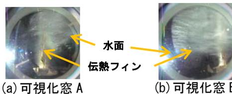
図4 限界熱流束到達直前の二相流動挙動
