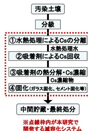
図 1 Cs 汚染土壤の減容化システム
