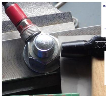
図 1 ボルト加振試験
