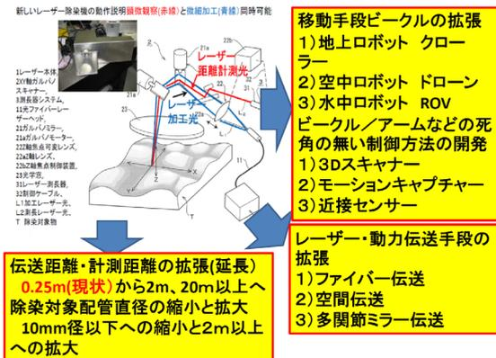
図、全自動レーザー除染装置の機能適用範囲の拡張説明。
