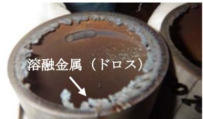
図1 炉浄化系設備 配管切断後
