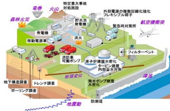
図6 新規基準による断層調査と各種重大事故対策
