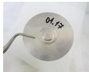
図1 Cs-137(200MBq)密封化線源
