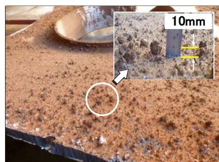
図1 SPINTA解体時のNa付着状態
