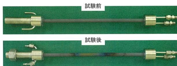
図 1,200°Cに昇温して1,000 sec保持した後に急冷した SiC 被覆管の試験前後の外観写真 (両端は試験治具)
