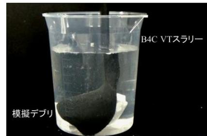
図 1. ビスコトップを用いた非溶解性中性子吸収材
