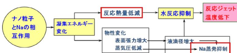
図1 ナノ流体適用による水反応抑制概念
