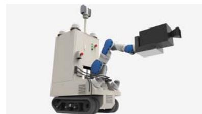
図2、ロボットレーザー除染機。
