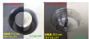
図-3 模擬試験体の切削結果
