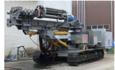
図-2 ロボットボーリングマシン
