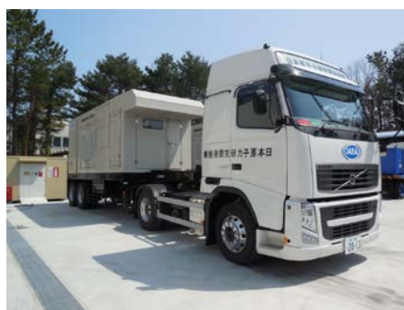
図 1 緊急用電源の確保（電源車）
