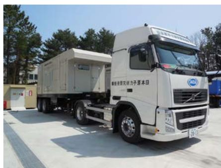
図 1 緊急用電源の確保（電源車）
