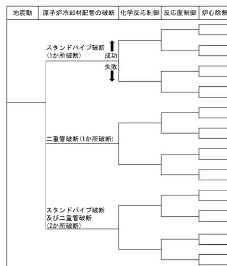
図 1 多分岐 ET 適用のイベントツリーモデル
