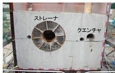
図 3 コンクリート充填状況
