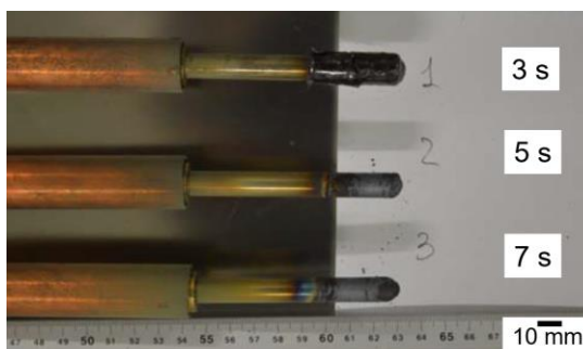
図 2 酸化物系コリウム中への浸漬後外観
