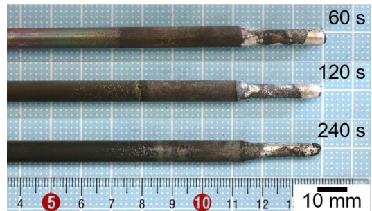
図 1 メタル系コリウム中への浸漬後外観
