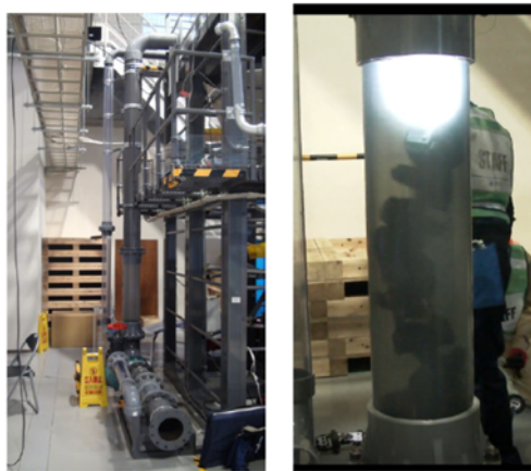
図5 ヘビ型ロボットの螺旋捻転運動による配管内走破
