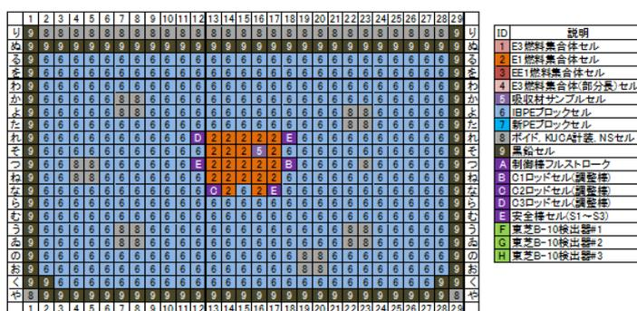
図2 炉心平面図(最適減速炉心)
