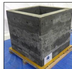
図 1 製作した貯蔵容器
