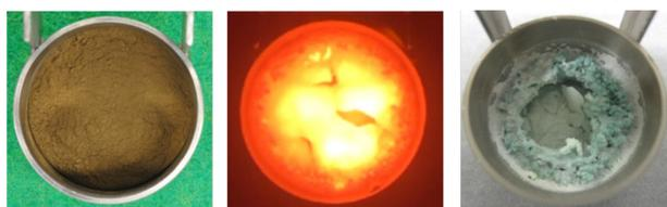
図1  $\text{UO}_2\text{-ZrO}_2\text{-Fe-B}_4\text{C-FP}$  (Cs, Sr, Nd) 模擬デブリのフッ化試験前・中・後の試料状況
