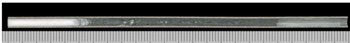
図 1  $Y_2O_3$ 5.5%含有  $ZrO_2$  のパルス加熱試験後の試料容器の断面
