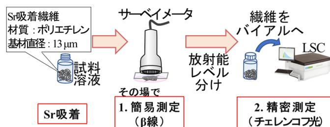
図1 想定する  $^{90}\text{Sr}$  その場分析への Sr 吸着繊維の適用フロー
