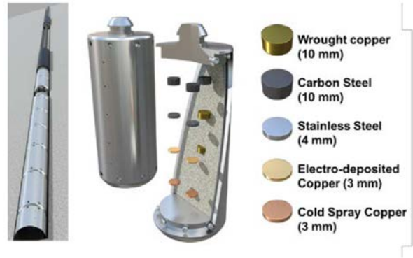
図-4 MaCoTe における原位置試験の概念図 1)
