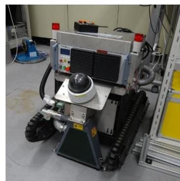
図.1. 床面専用ロボットレーザー除染装置外観
