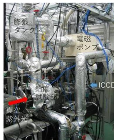
図 1 ナトリウム可視化試験装置
