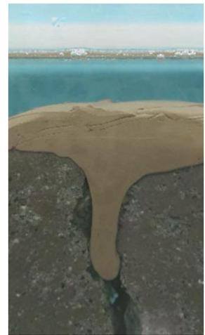
図 1. ビスコトップを用いた流動体の隙間流動性
