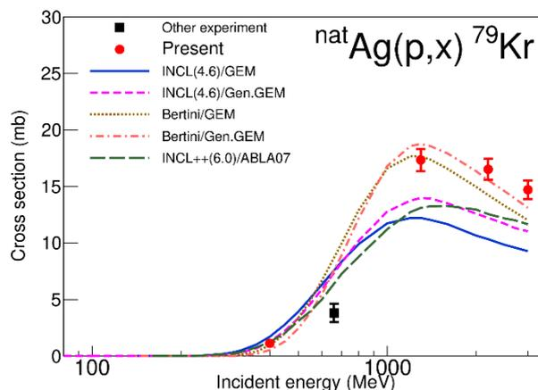
図 1  ${}^{\text{nat}}\text{Ag}(p,x){}^{79}\text{Kr}$  断面積
