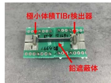
Fig.1 製作した指向性ガンマ線検出器
