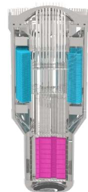
図2 一体型原子炉の概念図
