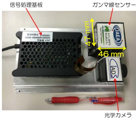
図1 小型・軽量コンプトンカメラの外観図。大きさを比較するためにボールペンを配置した。
