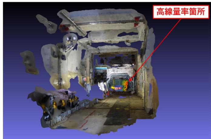
図4 複数枚の写真からフォトグラメトリ技術を用いて再構築した建屋内3次元モデルに、コンプトンカメラで取得したホットスポットのイメージを描画した。（原子力機構平成30年8月28日プレス発表資料より転載）
