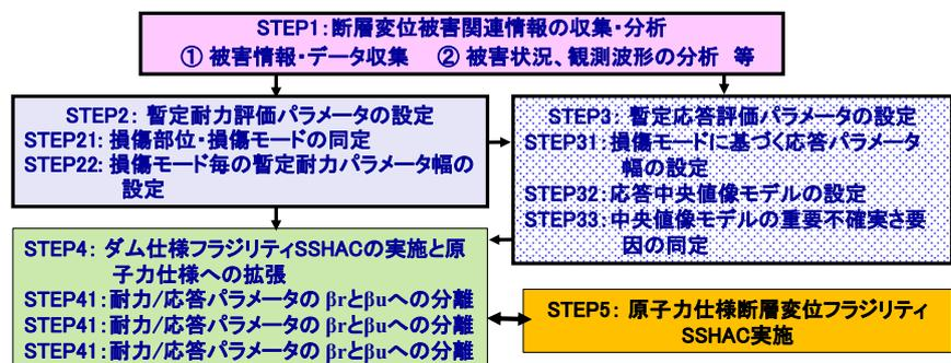
**図1 断層変位フラジリティ評価手法妥当性検討の枠組み及び手順**
