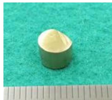
図 1 Zr-Nd 水素化物ペレットの外観
