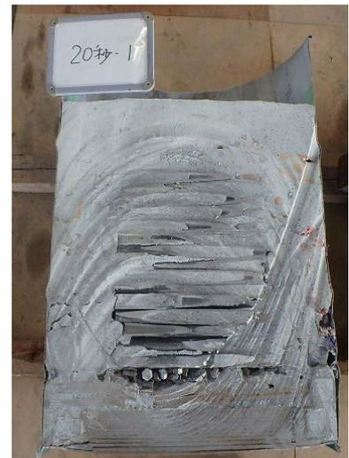
図2 固化化後の模擬廃棄体の断面
