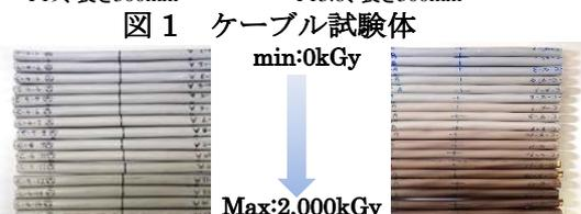
図2 C-4 室温照射後(左)と高温照射後(右)
