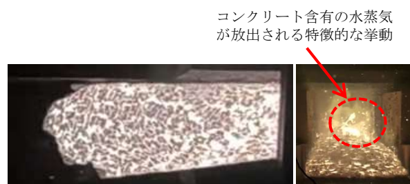
図 2 犠牲材コンクリート床拡がり実験結果
