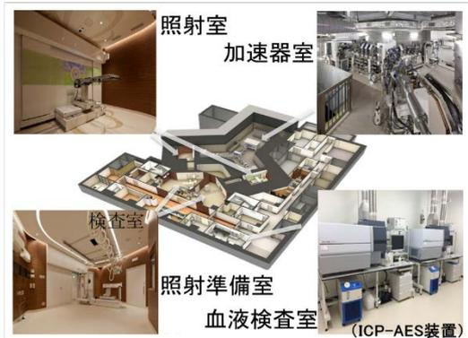
サイクロトロンで生成された陽子ビームは、照射室の手前に設置されたベリリウムターゲットに照射され、中性子に変換され、患者に照射される。患者は照射室前の準備室で固定され、照射室に自動で搬送される。
