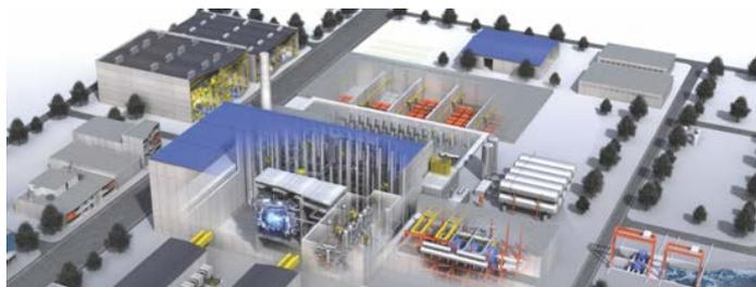
図 2 核融合原型炉プラントの全体像
