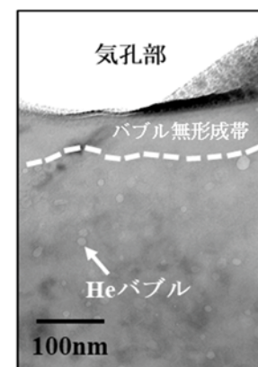
図 1 「常陽」照射 B 4 C 試料の明視野像 753~1176°C、33.7×10 20 cap/cm 3 、95%T.D.
