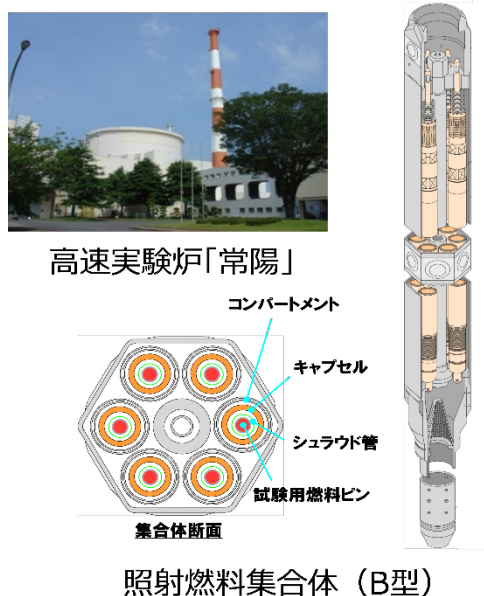
図1 高速実験炉「常陽」と照射燃料集合体例
