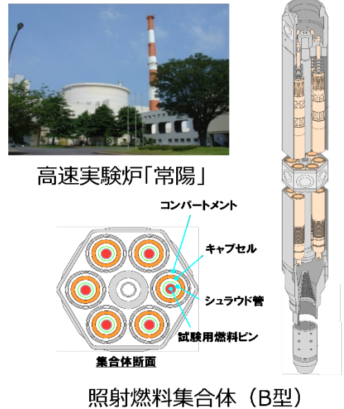
図1 高速実験炉「常陽」と照射燃料集合体例
