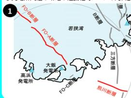
保守的に運動性等を評価し、地震想定を引上げ。(基準地震動  $S_s$ : 700ガル)
